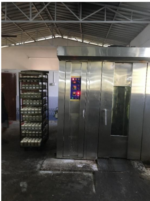
A Rotaryrack Baking Oven / Ein modernerer Umluftbackofen
